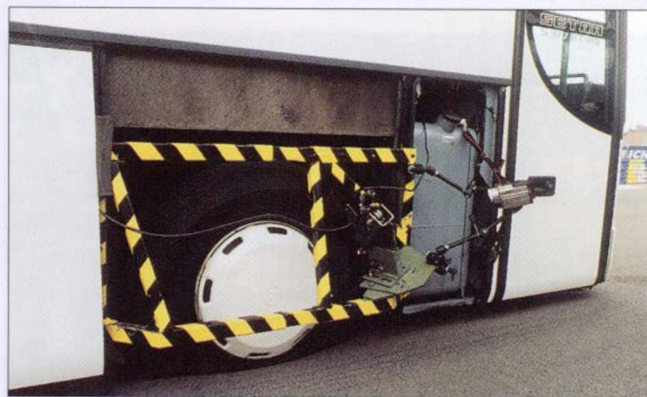
Diese Vorrichtung schlitzt den Pneu auf, wenige Zentimeter Bodenfreiheit bleiben.
